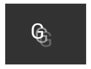
dl( BEGIN(BITMAPS) ); dl( VERTEX2II(50, 30, 31, 0x47) ); dl( COLOR\_A( 128 ) ); dl( VERTEX2II(58, 38, 31, 0x47) ); dl( COLOR\_A( 64 ) ); dl( VERTEX2II(66, 46, 31, 0x47) );
