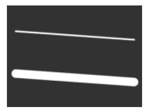
dl( BEGIN(LINES) ); dl( VERTEX2F(16 \* 10, 16 \* 30) ); dl( VERTEX2F(16 \* 150, 16 \* 40) ); dl( LINE\_WIDTH(80) ); dl( VERTEX2F(16 \* 10, 16 \* 80) ); dl( VERTEX2F(16 \* 150, 16 \* 90) );
