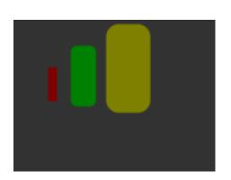
dl( COLOR\_RGB(128, 0, 0) ); dl( LINE\_WIDTH(1 \* 16) ); dl( BEGIN(RECTS) ); dl( VERTEX2F(28 \* 16,38 \* 16) ); dl( VERTEX2F(33 \* 16,63 \* 16) ); dl( COLOR\_RGB(0, 128, 0) ); dl( LINE\_WIDTH(5 \* 16) ); dl( VERTEX2F(50 \* 16,25 \* 16) ); dl( VERTEX2F(60 \* 16,63 \* 16) ); dl( COLOR\_RGB(128, 128, 0) ); dl( LINE\_WIDTH(10 \* 16) ); dl( VERTEX2F(83 \* 16, 13 \* 16) ); dl( VERTEX2F(98 \* 16, 63 \* 16) );
