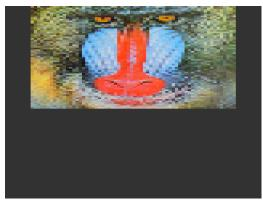
dl( BITMAP\_SOURCE(0) ); dl( BITMAP\_LAYOUT(RGB565, 128, 64) ); dl( BITMAP\_TRANSFORM\_A(128) ); dl( BITMAP\_SIZE(NEAREST, BORDER, BORDER, 128, 128) ); dl( BEGIN(BITMAPS) ); dl( VERTEX2II(16, 0, 0, 0) );
